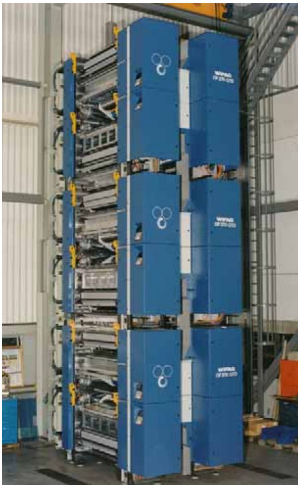
Bild 23: Die WIFAG OF 370 GTD wurde sogar in der Bauart eines 12er-Turms für Aarau, Schweiz, Syracuse, New York, USA, und für Villingen-Schwenningen, Deutschland, gebaut.
