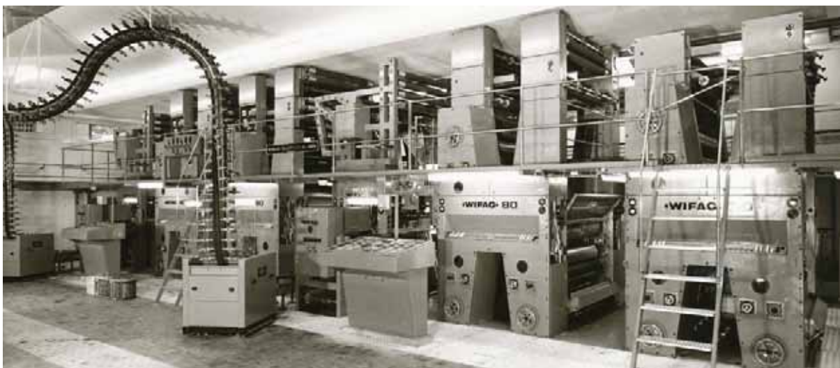
Bild 15: Ein absoluter Highlight wurde die Buchdruckrotation „WIFAG 80“ als damals schnellste Zeitungsdrukmaschine der Welt.
