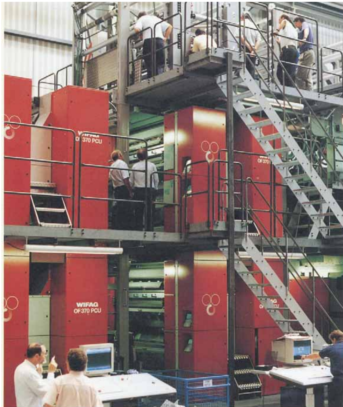
Bild 25: Die WIFAG OF 370 PCU erlaubte den fliegenden Seiten- und Umfangs- Wechsel - hier bei der Vorführung im Werk.
