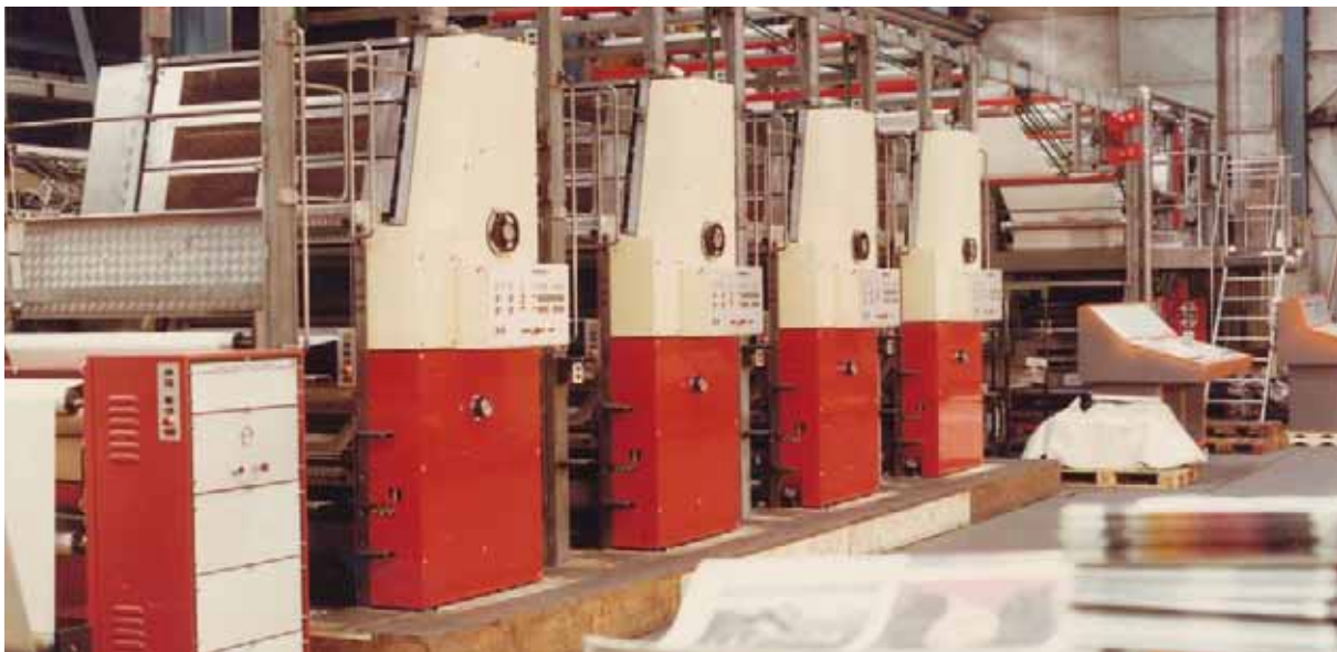
Bild 20: Ein kurzer Abstecher auf das Gebiet der Heatset-Akzidenzrollenoffset-Maschinen stellte die WIFAG OF 9.1 dar.
