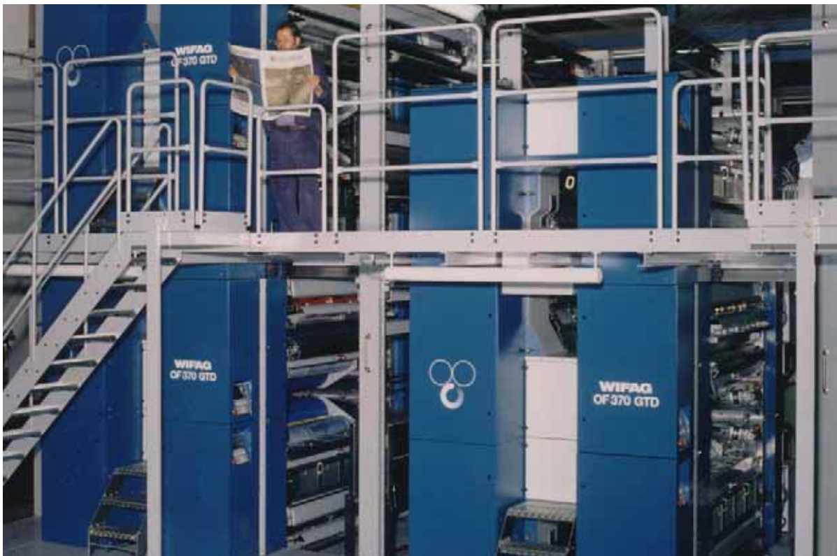
Bild 22: Die erste Offset-Zeitungsrotation ohne Längswellenverbindung, stattdessen mit Einzelantrieben, wurde die WIFAG OF 370 GTD.
