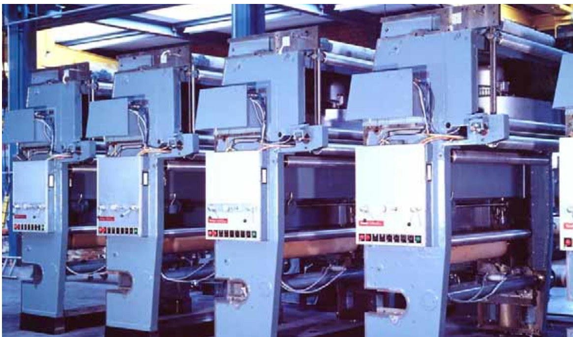
Bild 14: Die Druckwerke der Tiefdruckmaschine „WIFAG-Superrotomaster“ wurden Mitte der 1960er Jahre fast in Serie gebaut.
